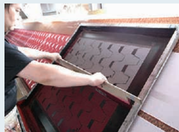
③下部の皿から適量の染料をスクージ(ヘラ)を使って上へ。
